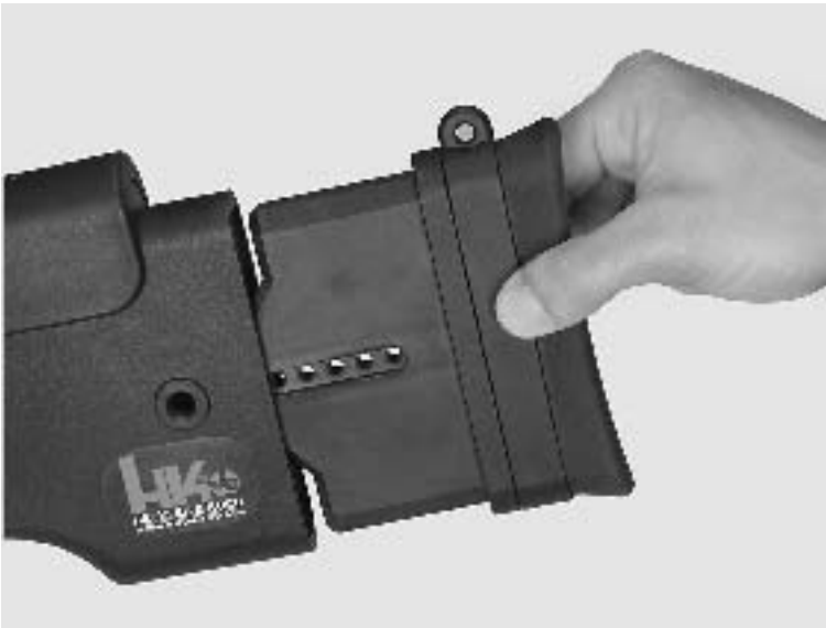
Bild 34 Kappe mit Distanzstück entnehmen
