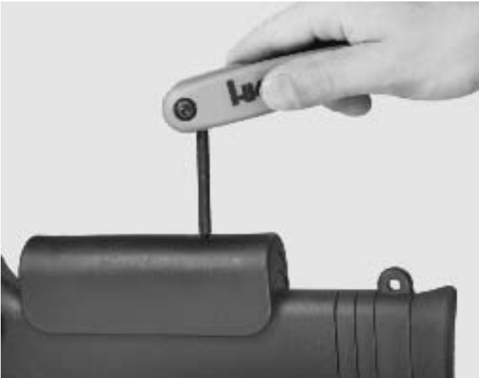
Bild 36 Wangenanlage anpassen und festschrauben
