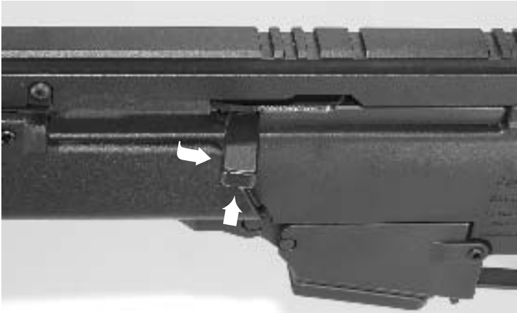
Bild 24 Ladehebel eindrücken (Schließhilfe)
