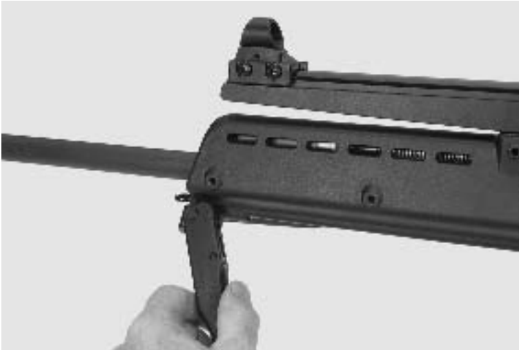
Bild 49 Eindrücken der Sperrhebel
