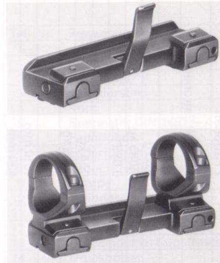
Mit unserer HK-Spannmontage 05 können alle handelsüblichen Zielfernrohre mit Höhen- und Seitenverstellung montiert werden. Verwenden Sie ein Zielfernrohr mit Schiene, lösen Sie die beiden Inbusschrauben an der Unterseite der Spannmontage 05 und schieben Sie das Zielfernrohr auf. Ziehen Sie die beiden Inbusschrauben fest an. Verwenden Sie ein Zielfernrohr ohne Schiene, benutzen Sie zusätzlich die Halteringe.
