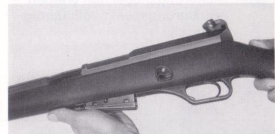
Während des Schließvorganges darf der Vorlauf des Durchladehebels nicht behindert werden.
