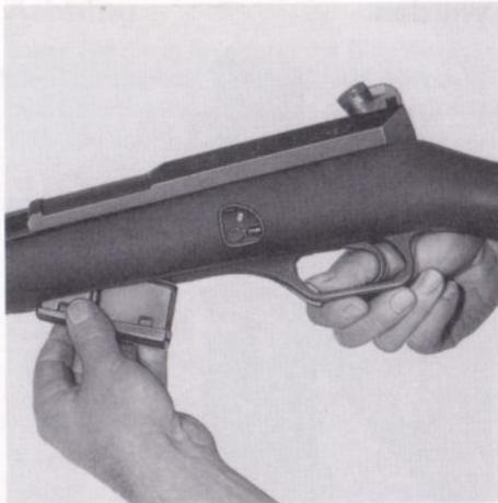
Magazin durch Eindrücken des Magazinhalters entnehmen. Durchladehebel zurückziehen und dabei die Waffe etwas nach der Seite hin neigen, damit die sich im Lauf befindliche Patrone über die Auswurföffnung in die Hand gleiten kann. Waffe schließen und den Abzug betätigen. Die Waffe ist ungeladen und entspannt.
