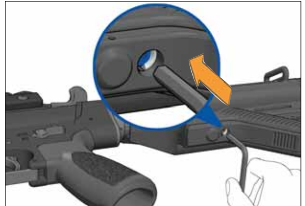
Abb. 25a: Innensechskantschlüssel in den Gewindestift
