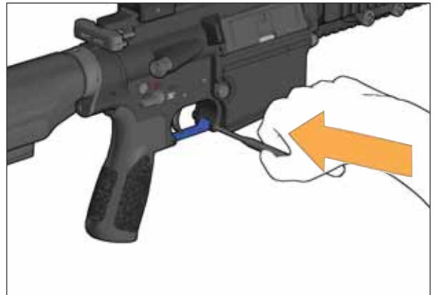
Abb. 26a: Abzugsbügel öffnen
