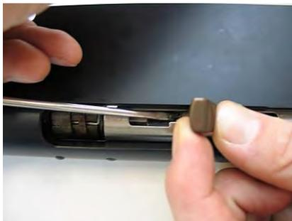
Retirer la culasse avec les tiges de transmission de la boîte de culasse.
