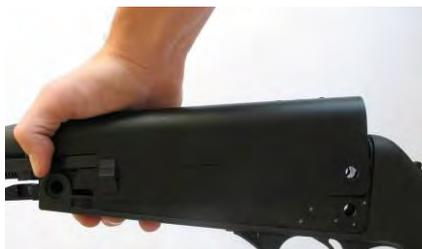
Introducir el guardamanos desde adelante y apretarlo con tornillos de cabeza cilíndrica.
