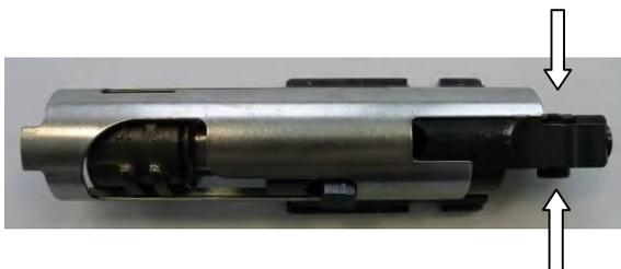
Introduire les deux tiges de transmission dans la boîte de culasse comme le montre l'image. Mettre en place l'ensemble de la culasse et l'introduire dans la boîte de culasse avec les tiges de transmission jusqu'au verrouillage de l'ensemble de la culasse. Lors de l'introduction, l'axe de commande doit se trouver en position avant.
