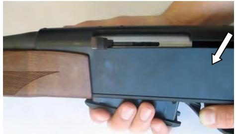
Gefülltes Magazin in den Magazinschacht einführen. Magazin zuerst vorne hochdrücken dann hinten hochdrücken bis Magazinhalter
