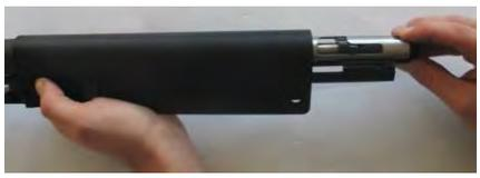
Insertar la palanca de armar en la escotadura y retirarla todo lo que dé en la ranura.
