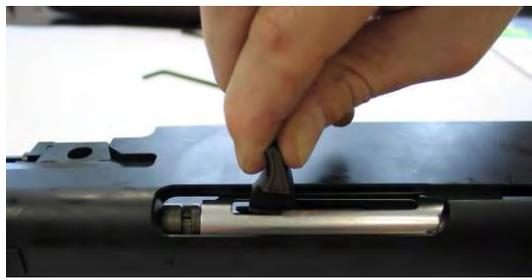
Colocar las barras de empuje en ambos lados de la unidad de accionamiento y fijarlos mediante clips de enchufe.
