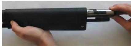
Ladehebel in Aussparung einsetzen und in Nut ganz zurückziehen.
