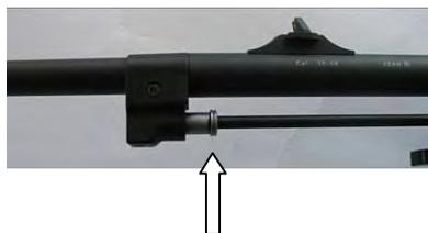
Dévisser et retirer les deux vis à six pans creux à l'arrière du corps de l'arme. Enlever l'axe. Enlever l'axe à l'arrière du corps de l'arme.
