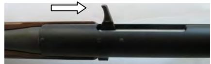
Estando el cargador vacío, el cierre se queda en la posición abierta. Después de accionarse la corredera se desengancha el cierre.
