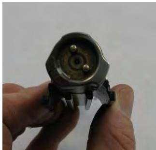
Bolzen eindrücken und mit Steckclip sichern.
