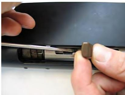
Quitar el conjunto del cierre con barras de empuje del cajón de los mecanismos.
