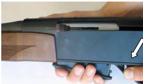
Basculer le chargeur garni vers le haut jusqu'à l'encliquetage de l'arrêt de chargeur.
