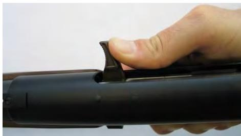
Sparando occorre fare attenzione che la leva di caricamento (che si muove anch'essa con la ripetizione) non venga ostacolata nella sua corsa.
