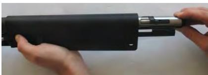
Inserire la leva di caricamento nella fessura e farla arretrare completamente nella scanalatura.
