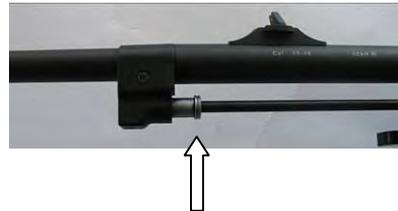
Zuerst die Schraube hinten am Gehäuse lösen und entfernen. Bolzen entnehmen. Bolzen vorne am Gehäuse entfernen.
