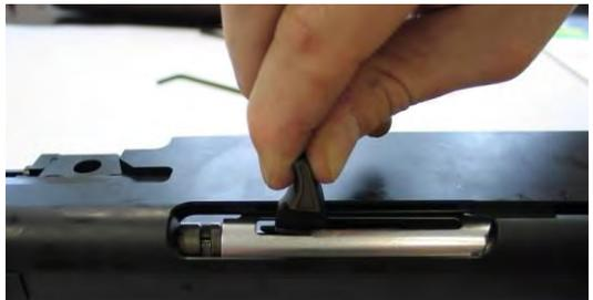
Schubstangen auf beiden Seiten des Antriebs aufstecken und mit Steckclips sichern.
