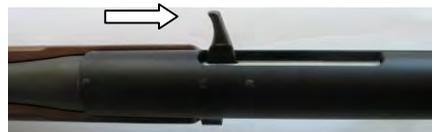
Bei leergeschossenem Magazin bleibt der Verschluss in hinterer Stellung. Nach Betätigen des Schiebers wird der Verschluss freigegeben.
