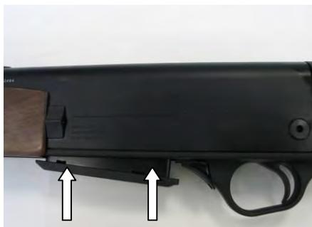
Tirer complètement la culasse vers l'arrière à l'aide du levier d'armement. Lâcher le levier d'armement. Après cela, une cartouche du chargeur est engagée dans la chambre.
