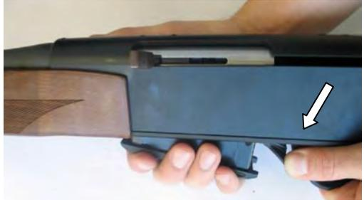
Introducir el cargador lleno horizontalmente en el pozo del cargador. Primero empujar la parte delantera del cargador hacia arriba, luego empujar la parte de atrás hasta que enganche el retén del cargador.
