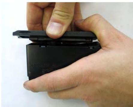
Positionner la cheville de l'insert dans l'orifice du fond du chargeur jusqu'à ce qu'elle s'encliquète dans le fond du chargeur.
