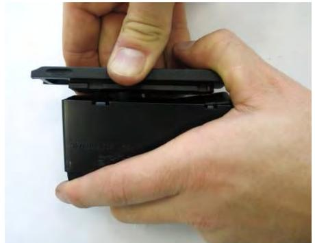
Colocar el saliente de la placa de fondo del cargador en el taladro de la tapa del fondo del cargador.
