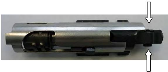
Introducir las dos barras guía en el cajón de mecanismos como se muestra en la imagen. Colocar el conjunto del cierre e introducirlo en el cajón de mecanismos junto con las barras de empuje hasta que se acerque el conjunto del cierre. Al introducirse el conjunto del cierre, el perno de mando debe encontrarse en posición delantera.
