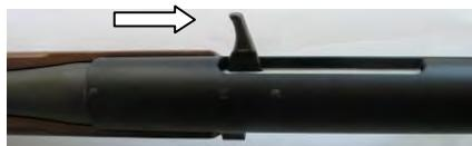
Quando, sparando, si svuota il caricatore, l'otturatore rimane aperto in posizione arretrata. Azionando il cursore, l'otturatore torna nella sua posizione di chiusura.
