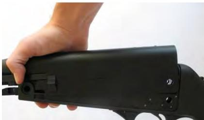
Introduire le garde-main par l'avant et le fixer à l'aide des vis à tête cylindrique. Veiller à ce que le canon soit installé au centre du garde-mains.
