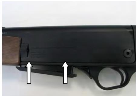
Den Verschluss mittels Ladehebel ganz zurückziehen. Ladehebel loslassen. Nach der Freigabe des Ladehebels wird eine Patrone aus dem Magazin in das Patronenlager zugeführt.
