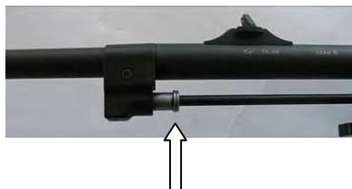
Allentare dapprima la vite nella parte posteriore della carcassa e rimuoverla. Estrarre i perni. Rimuovere i perni nella parte anteriore della carcassa.
