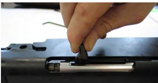
Enficher les tiges de transmission des deux côtés de l'unité d'actionnement et les fixer avec les clips enfichables.
