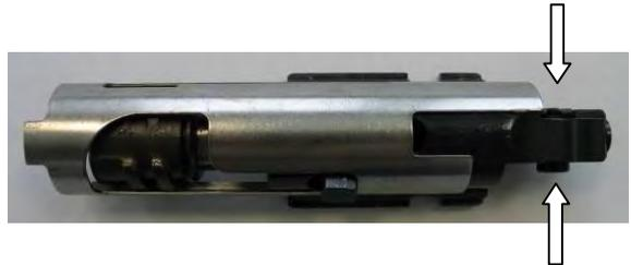
Die beiden Schubstangen wie abgebildet in die Hülse einführen.
