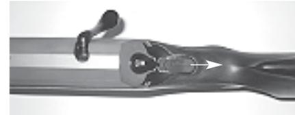
Sicherungsschieber ganz nach hinten auf gesichert betätigen.
