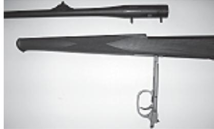
Lauf entnehmen. Gewünschter Lauf einsetzen. Schrauben (2 Stck.) fest anziehen. Klappdeckel anklappen.
