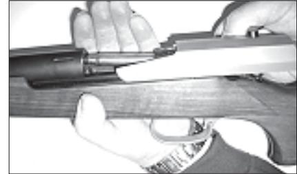
Verschluss mittels Kammerstengel öffnen und Patrone entnehmen.
