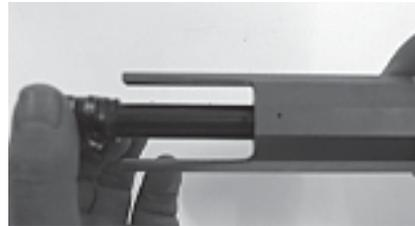
Verschlusskopf in Verschlussträger einführen.
