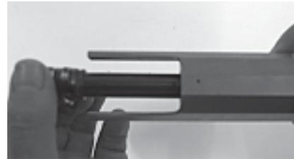
Verschlusskopf in Verschlussträger einführen.
