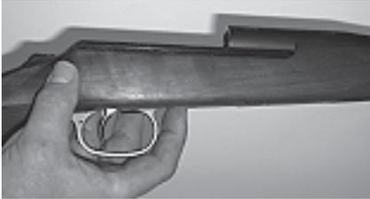
Drücker nach hinten ziehen. (Klappdeckel klappt ab). Magazin entnehmen.
