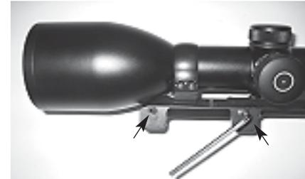
Zum Einstellen des Drehmoments der beiden Hebeln, müssen die Schrauben auf der linken Seite gelöst werden. Mit den dahinterliegenden Schrauben kann das Drehmoment eingestellt werden.
