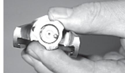
Verschlusskopf so positionieren, dass der Auszieher rechts – (in Schussrichtung)
