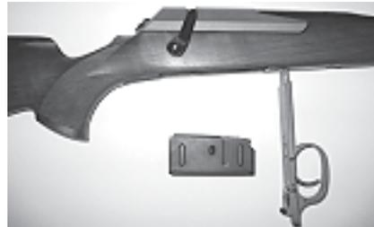
Drücker nach hinten ziehen. Klappdeckel klappt ab. Magazin entnehmen und entladen.
