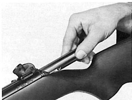
Waffe mit Mündung nach unten halten, Ladehebel bis zum Einrasten nach hinten ziehen. Verschluß (Auszieher unten) bei gleichzeitigem leichtem Drehen nach links und rechts wieder einführen und bis zum Anschlag nach vorne gleiten lassen. Puffer, mit Aussparung nach vorne unten, einsetzen, Haltebolzen anbringen.
