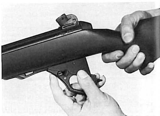
Abzugskasten einsetzen und einrasten lassen.
