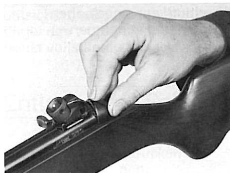
Abschlußkappe aufsetzen. Rasthebel drücken, der Verschluß gleitet ganz nach vorn.
