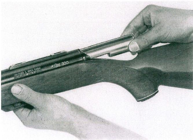
Waffe mit Mündung nach unten halten, Ladehebel bis zum Einrasten nach hinten ziehen. Verschuß (Auszieher unten) bei gleichzeitigem leichtem Drehen nach links und rechts wieder einführen und bis zum Anschlag nach vorne gleiten lassen. Puffer, mit Aussparung nach vorne unten, einsetzen, Haltebolzen anbringen.
