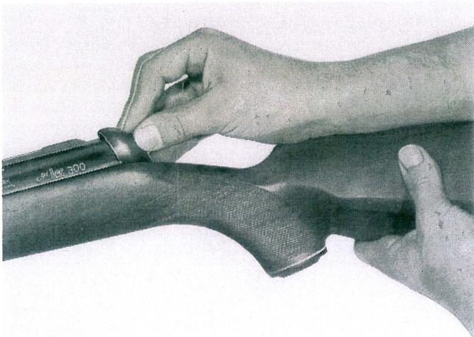
Abschlußkappe aufsetzen. Rasthebel drücken, der Verschuß gleitet ganz nach vorn.
