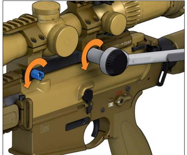
Abb. 56a: Zielfernrohr ZF 3-20 x 50 demontieren
