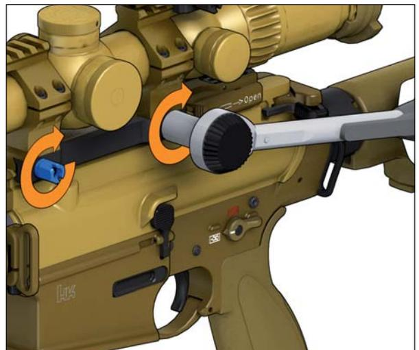
Abb. 69a: Schrauben des ZF-Halters mit Drehmomentschlüssel festziehen
