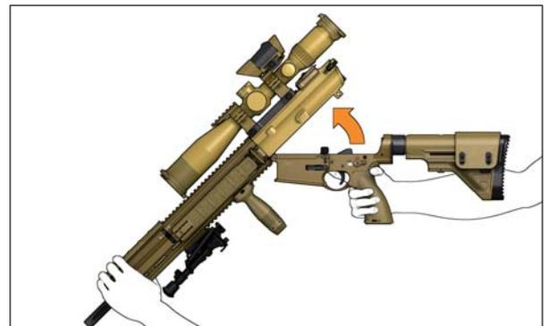
Abb. 68b: Gehäuseunterteil und Gehäuseoberteil zusammensetzen
