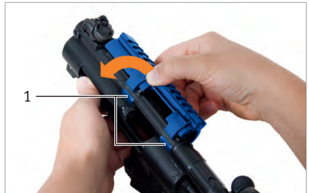
Abb. 34: Adapter mit Picatinny-Schiene montieren
