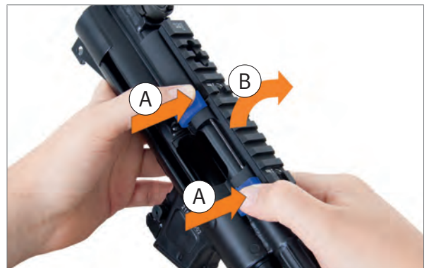
Abb. 29: Adapter mit Picatinny-Schiene entnehmen
