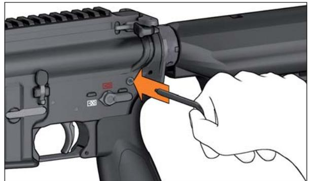
*Abb. 43a: Hinteren Haltebolzen nach rechts eindrücken*
