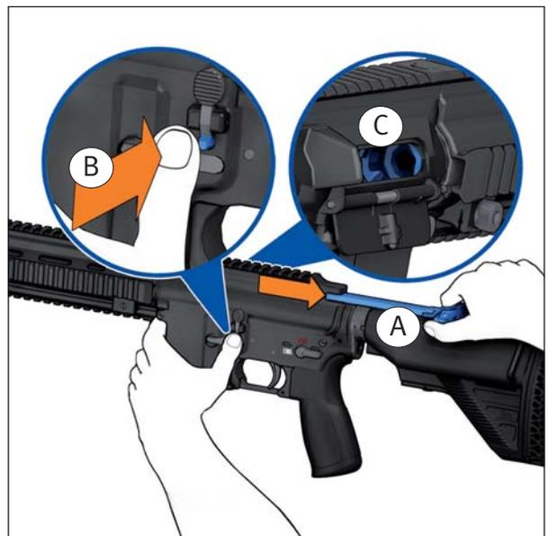
Abb. 25a: Sicherheitsprüfung durchführen
